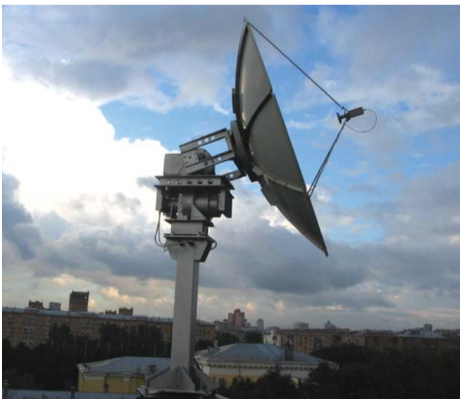
Станция приема изображений «Унискан-36», установленная на крыше корпуса высоких энергий НИИЯФ им. Д.В. Скобельцына
