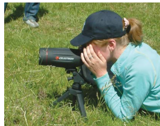
Поиск геодезических знаков с помощью телескопа наблюдения
