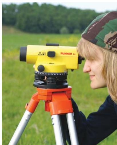
Топографическая практика: нивелир Runner (производство Leica, Швейцария)
