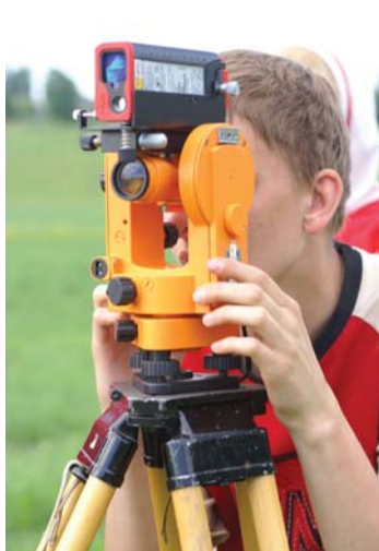
Топографическая практика: теодолит 4T30P с лазерным дальномером
