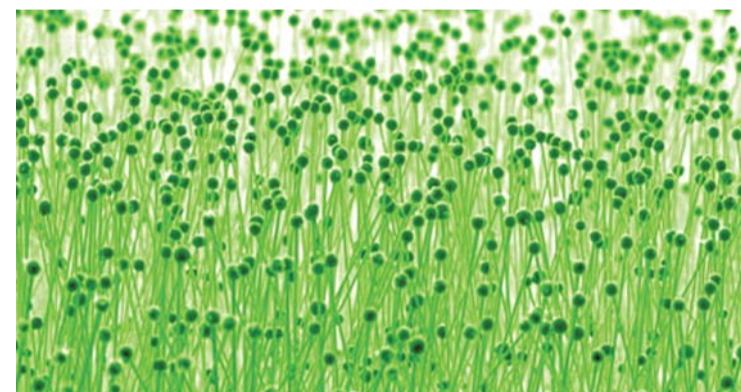
Нанощуры оксида цинка, синтез которых катализирует германий (Ge — шарики на кончиках)
